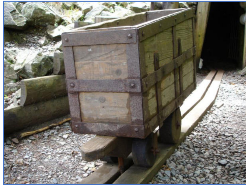
Bild 02: Spurnagelhunt, Lothringen (Holz neu, Beschläge original)
